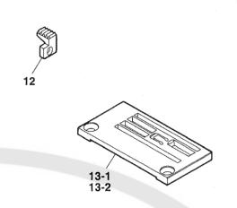
EXTRA PARTS Stitch tongue of P. F. for using machine without spreader thread. 上飾りなし使用時の押エ爪
