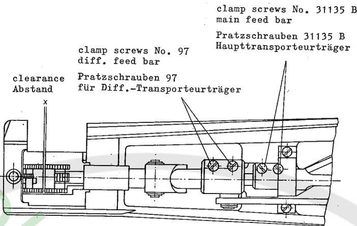
Die Transporteurträger sind nun zugänglich und können nach dem Lösen der Pratzschrauben 31135 B und 97 verstellt werden (siehe Abbildung). Nach erfolgter Einstellung sind die Pratzschrauben wieder gut anzuziehen und der Zylinderdeckel sauber auf die Dichtung aufzusetzen. Sollten die Korkdichtungen und die Gummischnur an den Stirnseiten des Zylinderdeckels beschädigt sein, so sind diese durch neue Dichtungen zu ersetzen.
