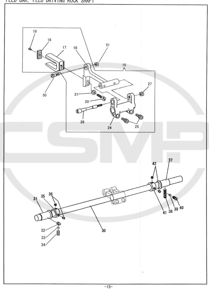
送り土台、送り軸 FEED BAR、FEED DRIVING ROCK SHAFT
