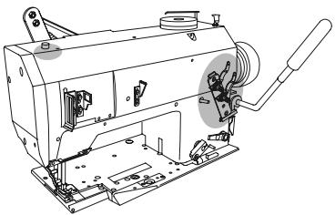
Pneumatische Spannungslüftung (-906/07)
