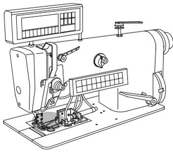
Einrichtung zum Beschneiden der oberen Stofflage
