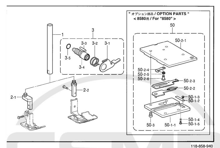
Y1 . 電磁押工上ゲセット関係 (輸出用) / Presser foot lifting solenoid set (8580-901)
