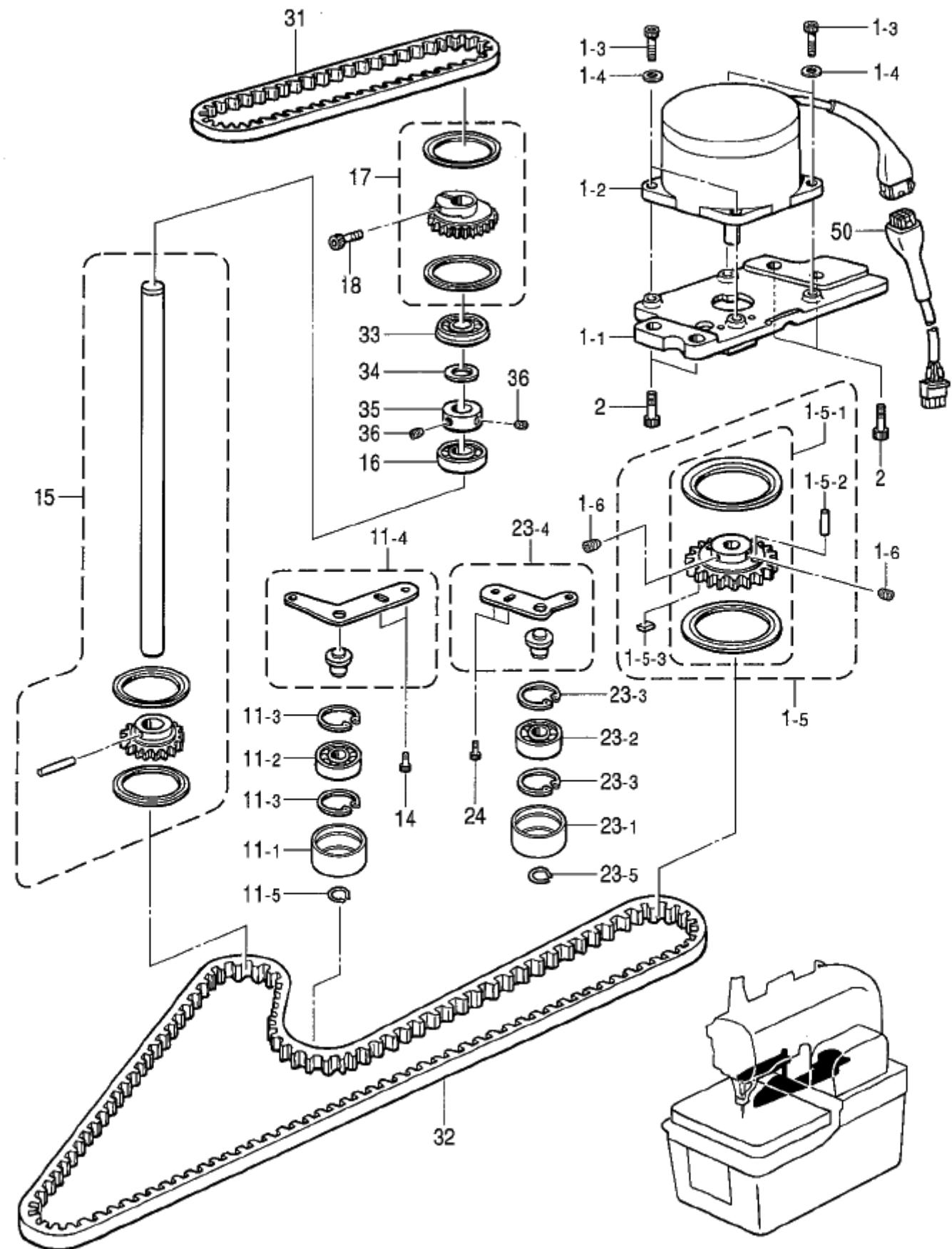
E . 針棒搖動関係 / Needle bar rocking mechanism
