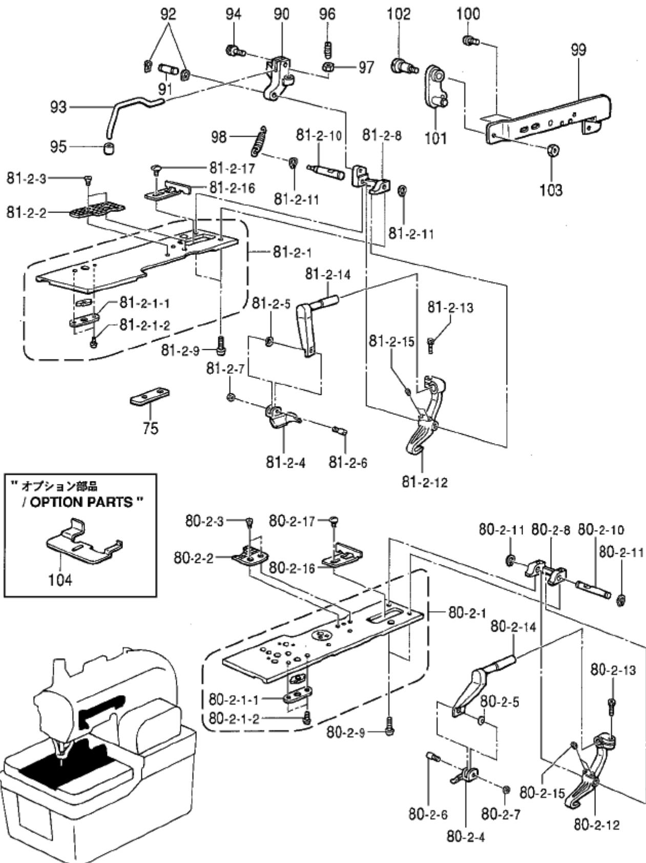
F3 . 押工関係 (ジーンズ仕様) / Presser foot mechanism (Jeans specification)
