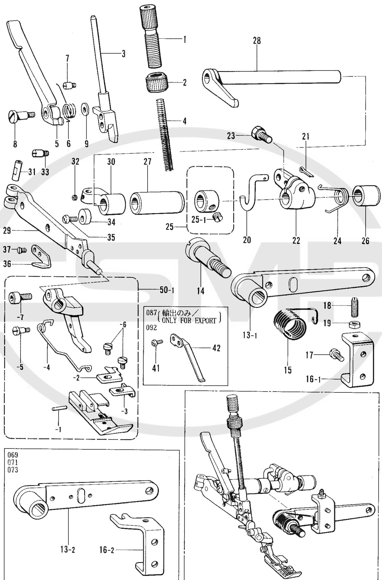
E. 押工関係/Presser foot mechanism/Stoffdrückerfuß/
