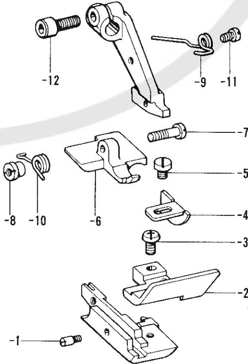
E. 押工関係/Presser foot mechanism/Stoffdrückerfuß/
