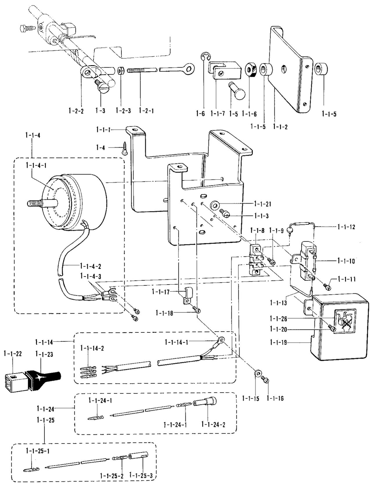
V1. 電磁押工上ゲ関係/Presser foot lifting solenoid set/
