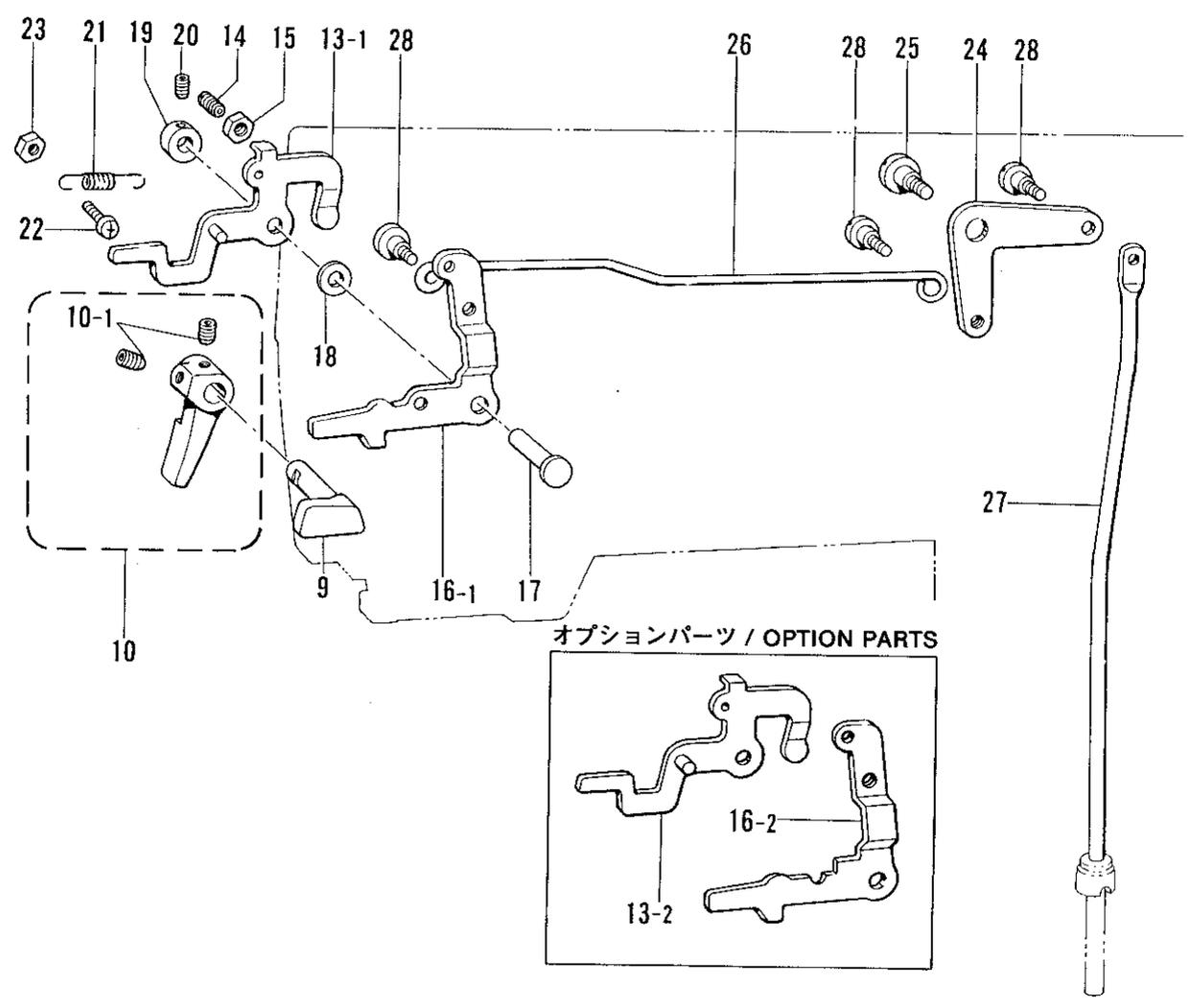
D. 押工関係/Presser foot mechanism/Stoffdrückerfuß/
