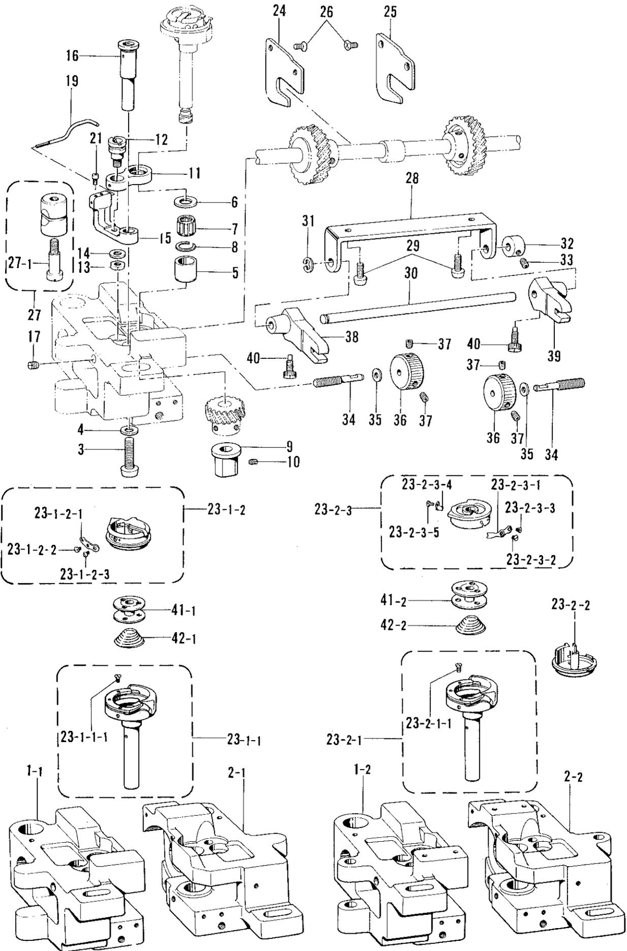
K. カマ関係 / Rotary hook mechanism / Greifervorrichtung /
