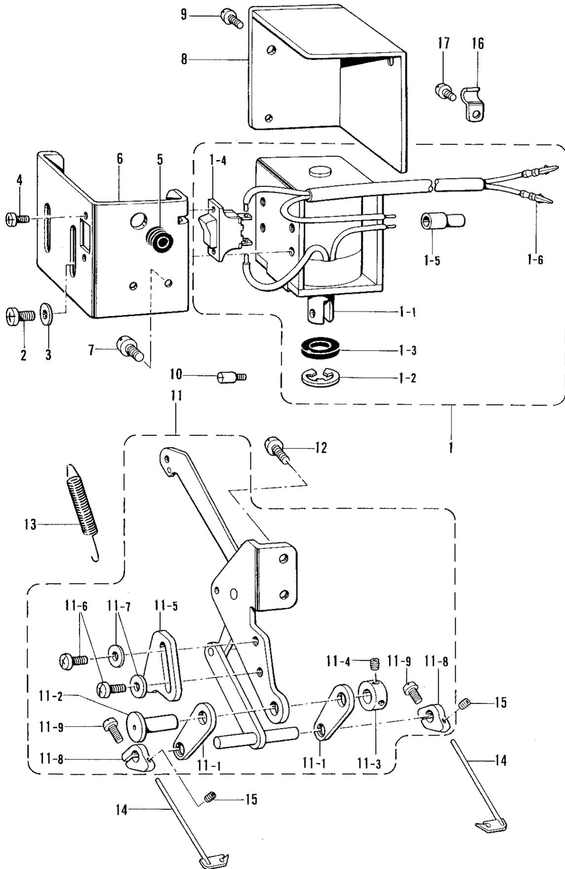
R. 糸払イ関係 (糸切り) / Thread wiper mechanism (Thread Trimmer) / Fadenwischvorrichtung (Fadenabschneider) /
