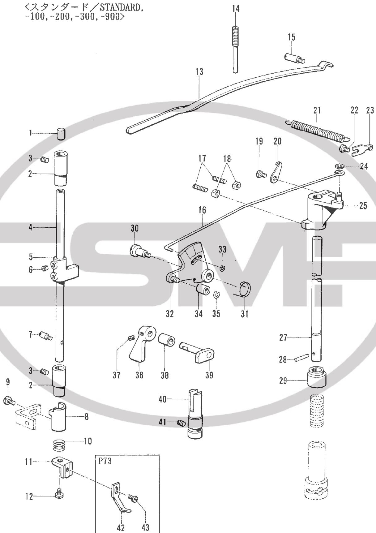
E. 押工関係/Presser foot mechanism/Stoffdrückerfuß/
