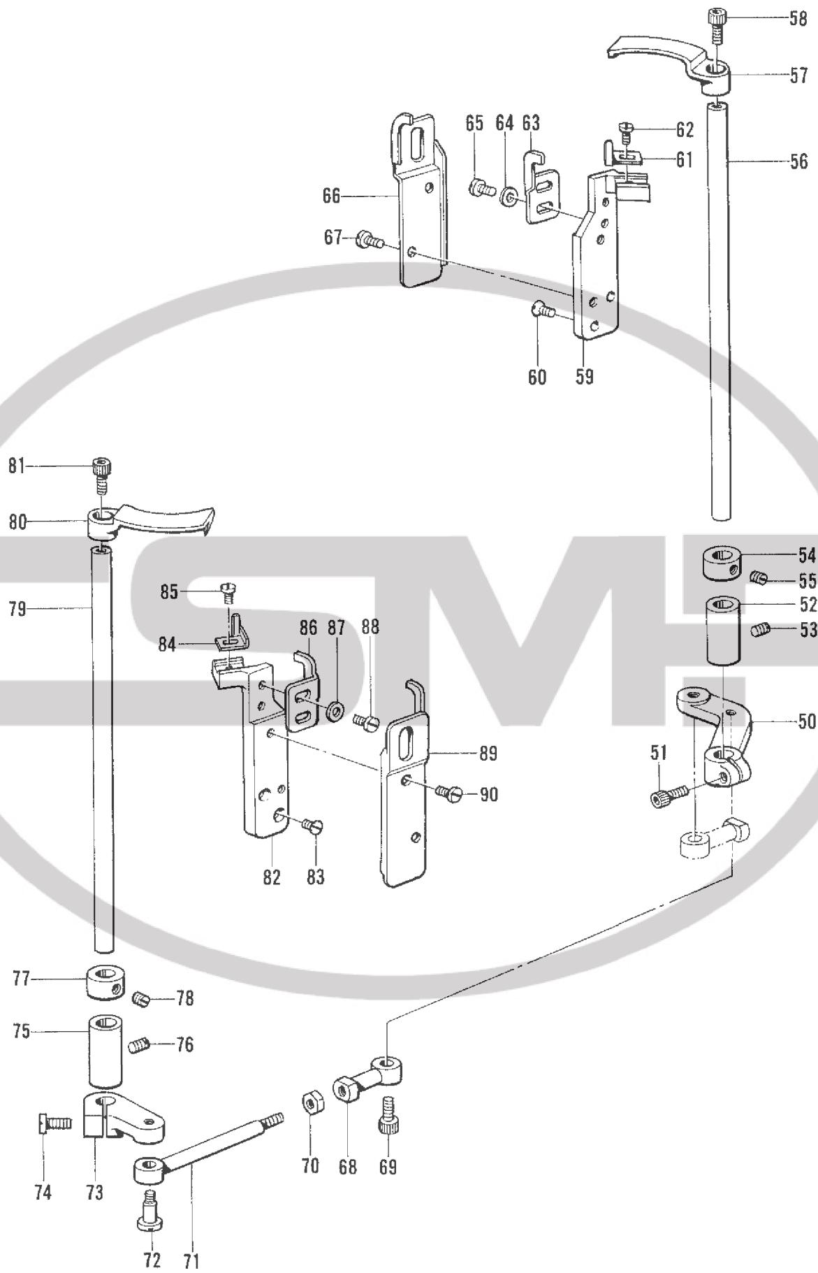
N2. 糸切り関係/Thread trimmer mechanism/Fadenabschneidevorrichtung/
