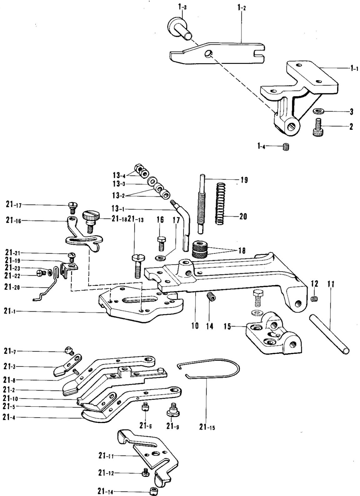
G. ボタンツマミ作動関係/ Button clamp mechanism/ Knopfhaltevorrichtung/
