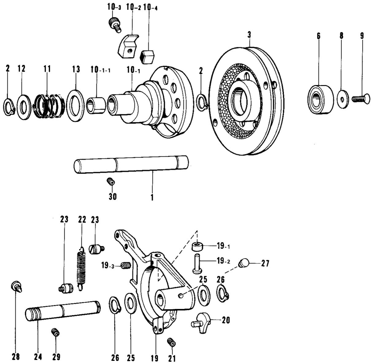
D. パワー押工関係/Power lift mechanism/Heberbetätigungsvorrichtung/
