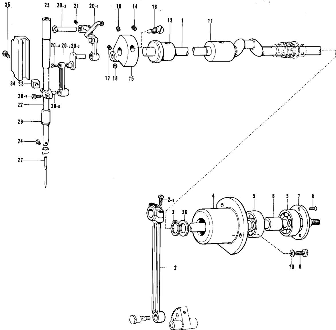
C. 上軸・針棒関係/Upper shaft and needle bar mechanism/Obere Welle und Nadelstange/
