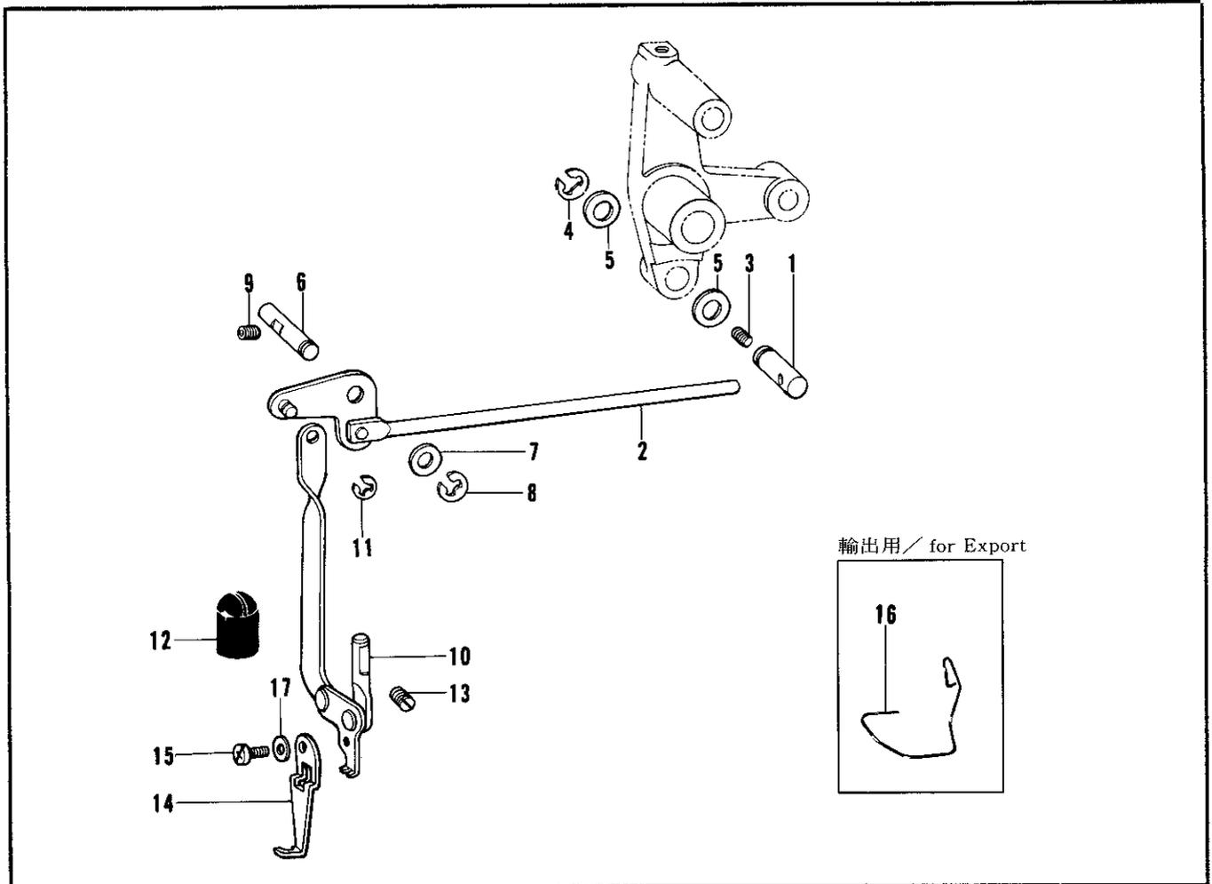
Q. 糸締×関係 / Thread nipper mechanism / Fadenspannvorrichtung
