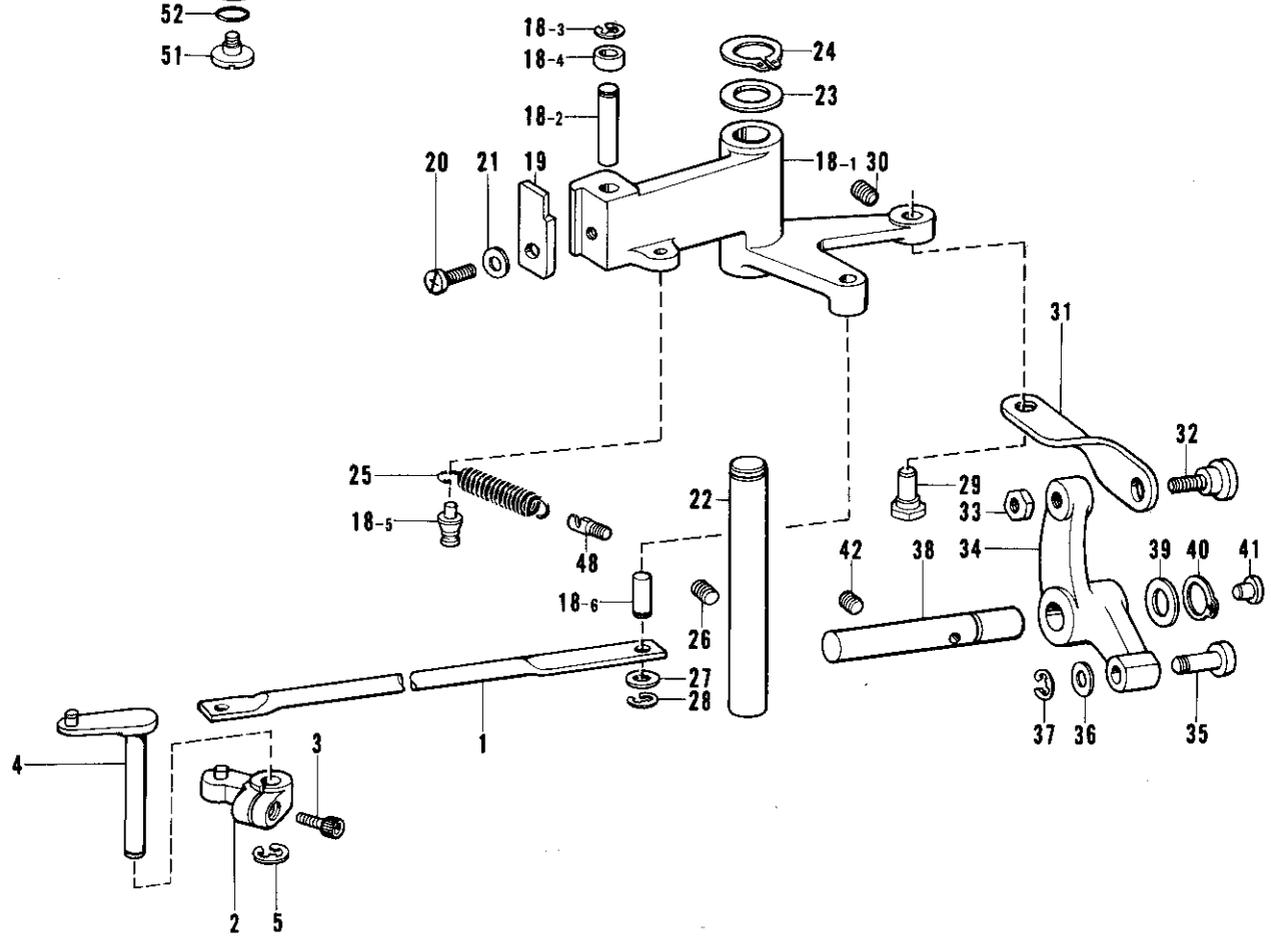
N. 糸切り関係/Thread trimmer mechanism/Fadenabschneidevorrichtung
