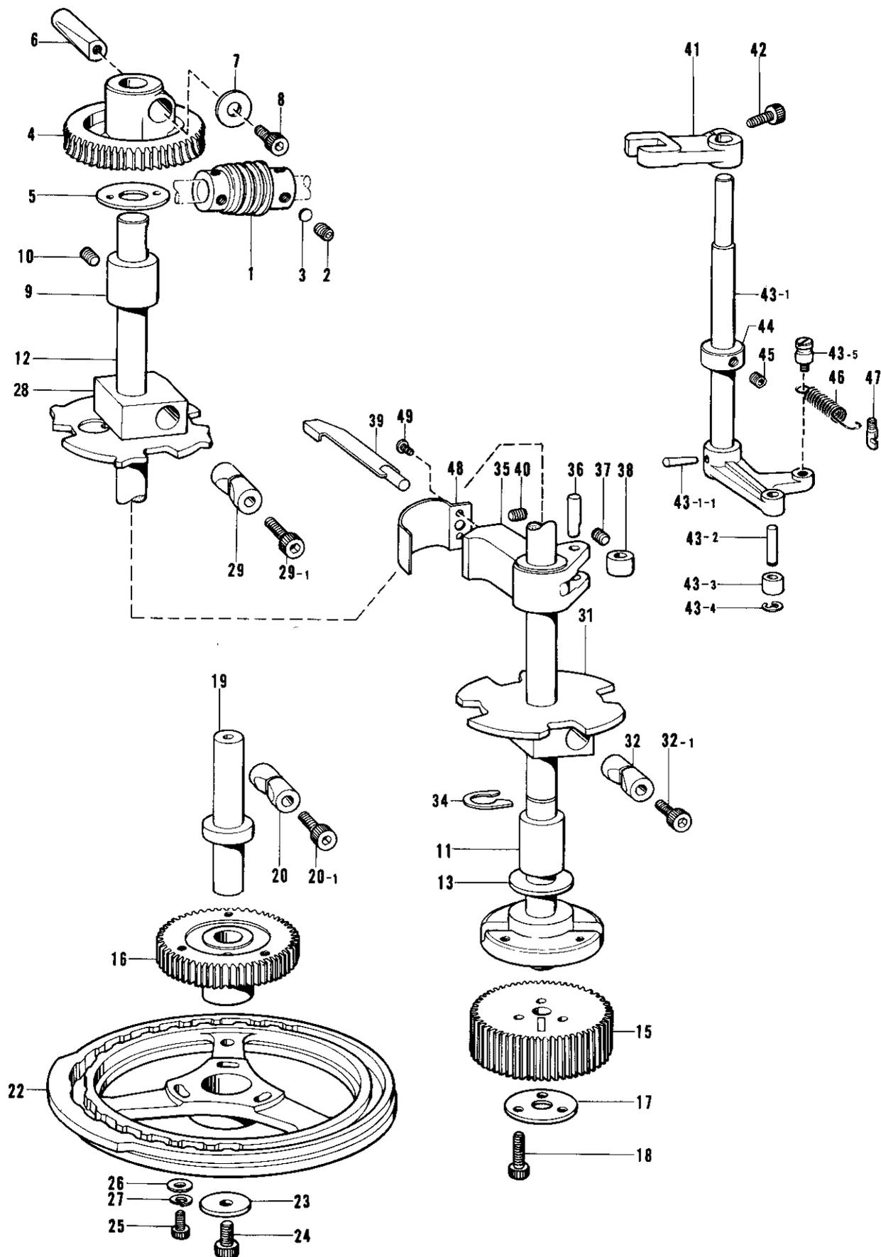
H. カム伝導関係/Feed cam mechanism/Vertikale Welle/
