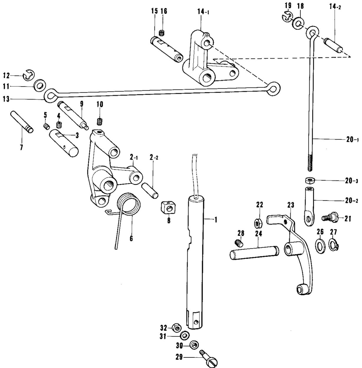
F. 押工上げ関係/Work clamp lifter mechanism/Stoffhalterhebevorrichtung/
