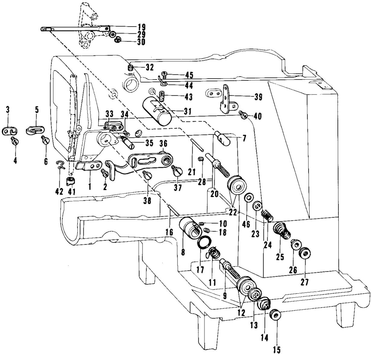
L. 糸通シ関係 / Threading mechanism / Fadenführungsrichtung
