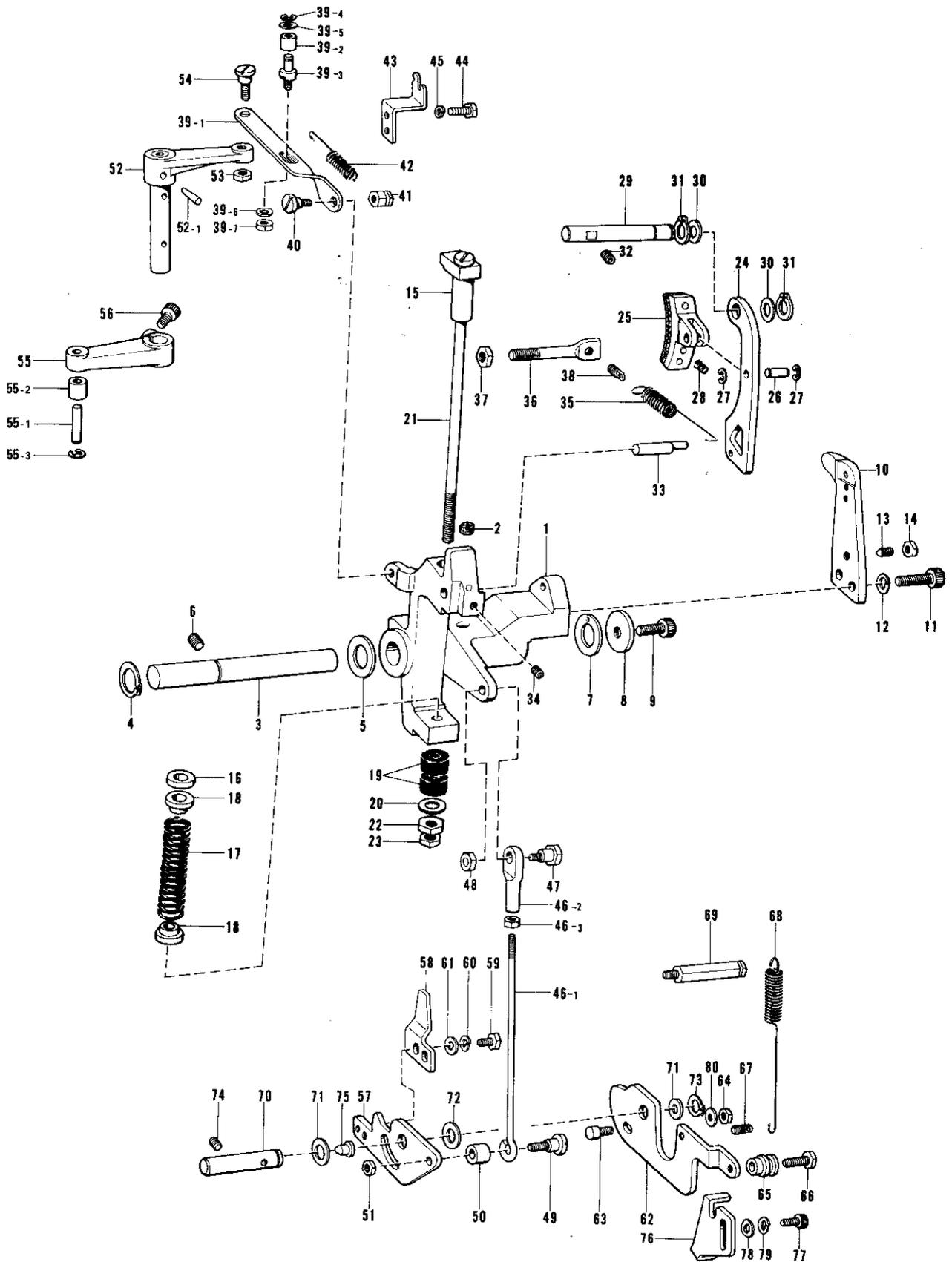
B. クラッチ関係 / Clutch mechanism / Kupplungsvorrichtung /
