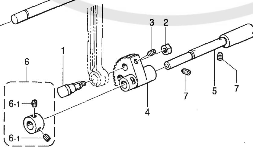
F. 下軸関係 / Lower shaft mechanism / Untere Welle / Mécanisme de l'arbre inférieur /
