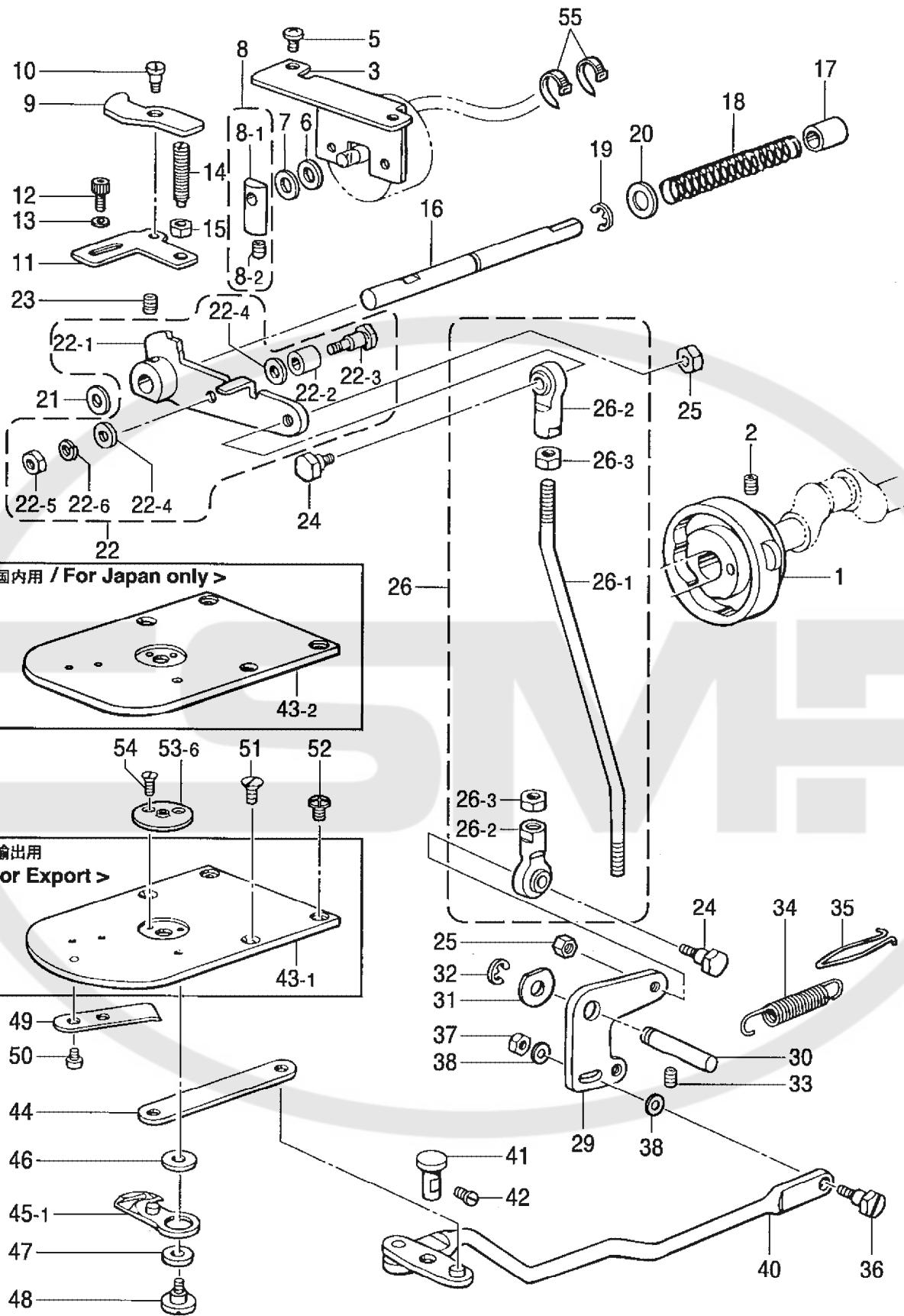
K. 糸切り関係 / Thread trimmer mechanism / Fadenabschneidevorrichtung /
