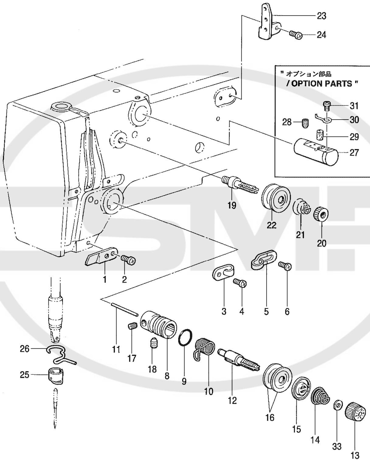
H. 糸通シ関係 / Threading mechanism / Fadenführungs vorrichtung / Mécanisme de l'enfilage / Mecanismo del enhebrado
