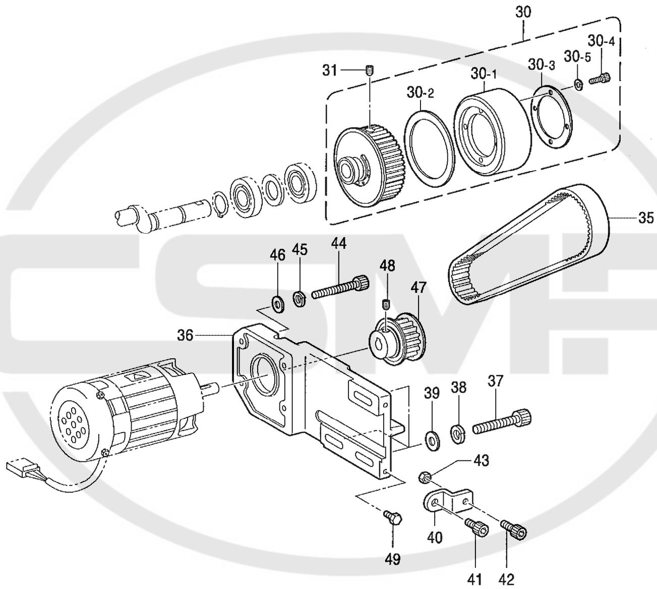
B2. 上軸・針棒関係 / Upper shaft and needle bar mechanism / Obere Welle und Nadelstangenvorrichtung /
