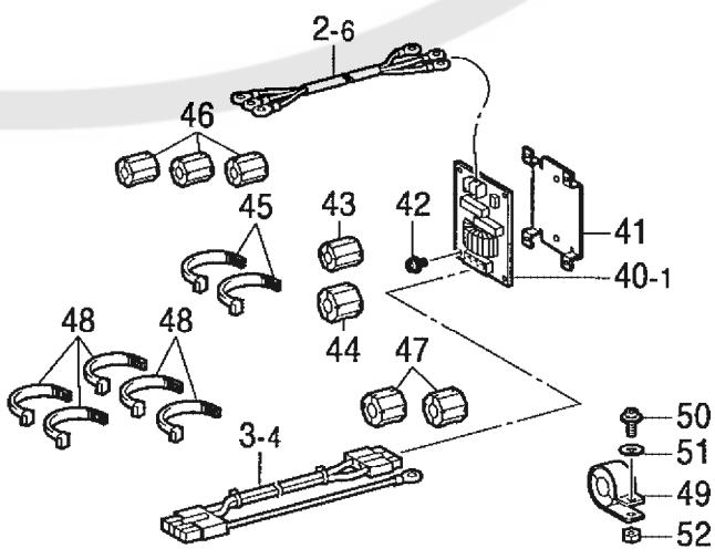
R2. コントロールボックス関係 / Control box mechanism / Schaltkasten /
