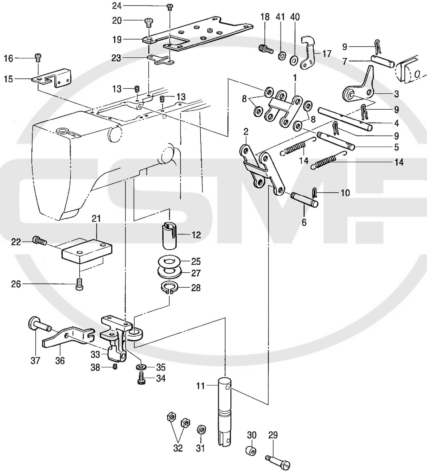
D. 押工上げ関係 / Work clamp lifter mechanism / Stoffhalterheber / Releveur de pinceur /
