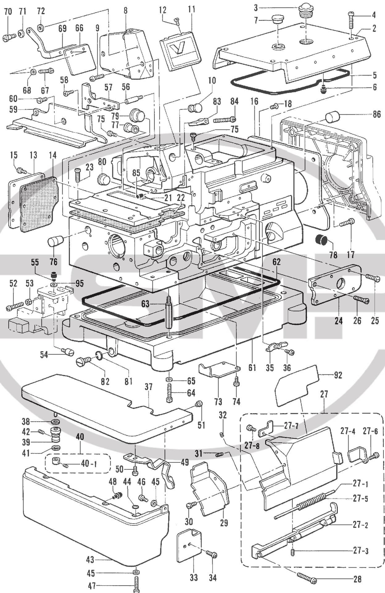
A. フレーム関係/Machine body/Maschinengehäuse/
