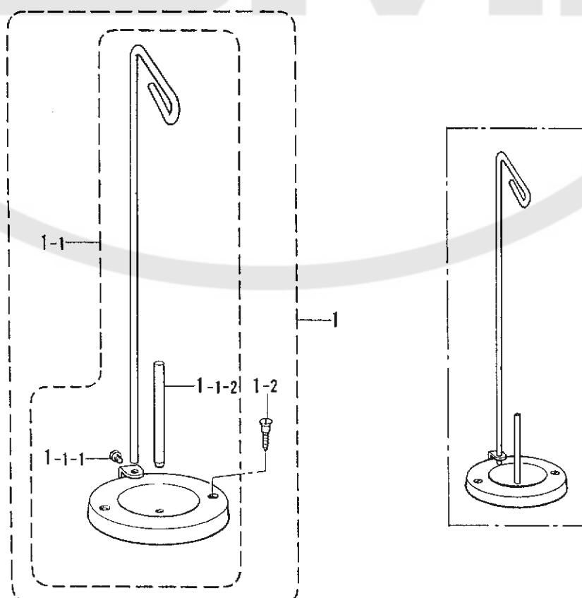
L. 針冷却装置/Needle cooler/Nadelkühlungsvorrichtung/
