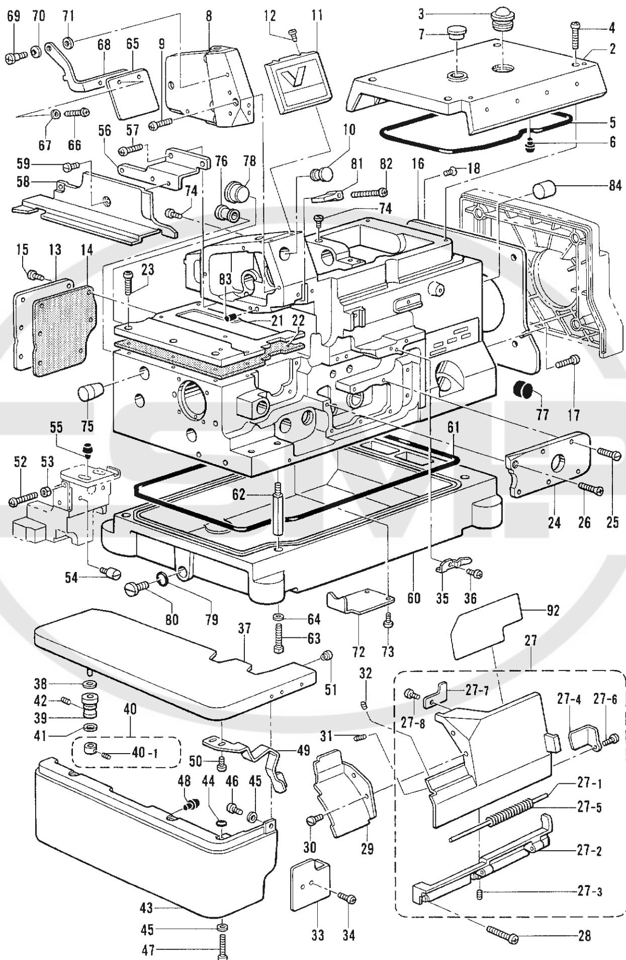
A. フレーム関係 /Machine body/Maschinengehäuse/
