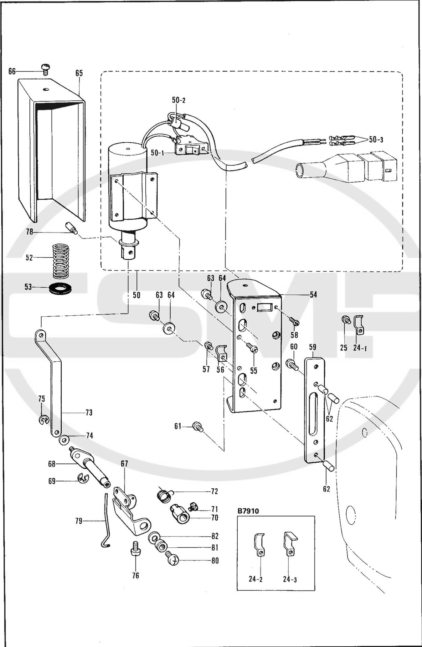
P. 糸払イ関係 / Thread wiper mechanism / Fadenspannvorrichtung /
