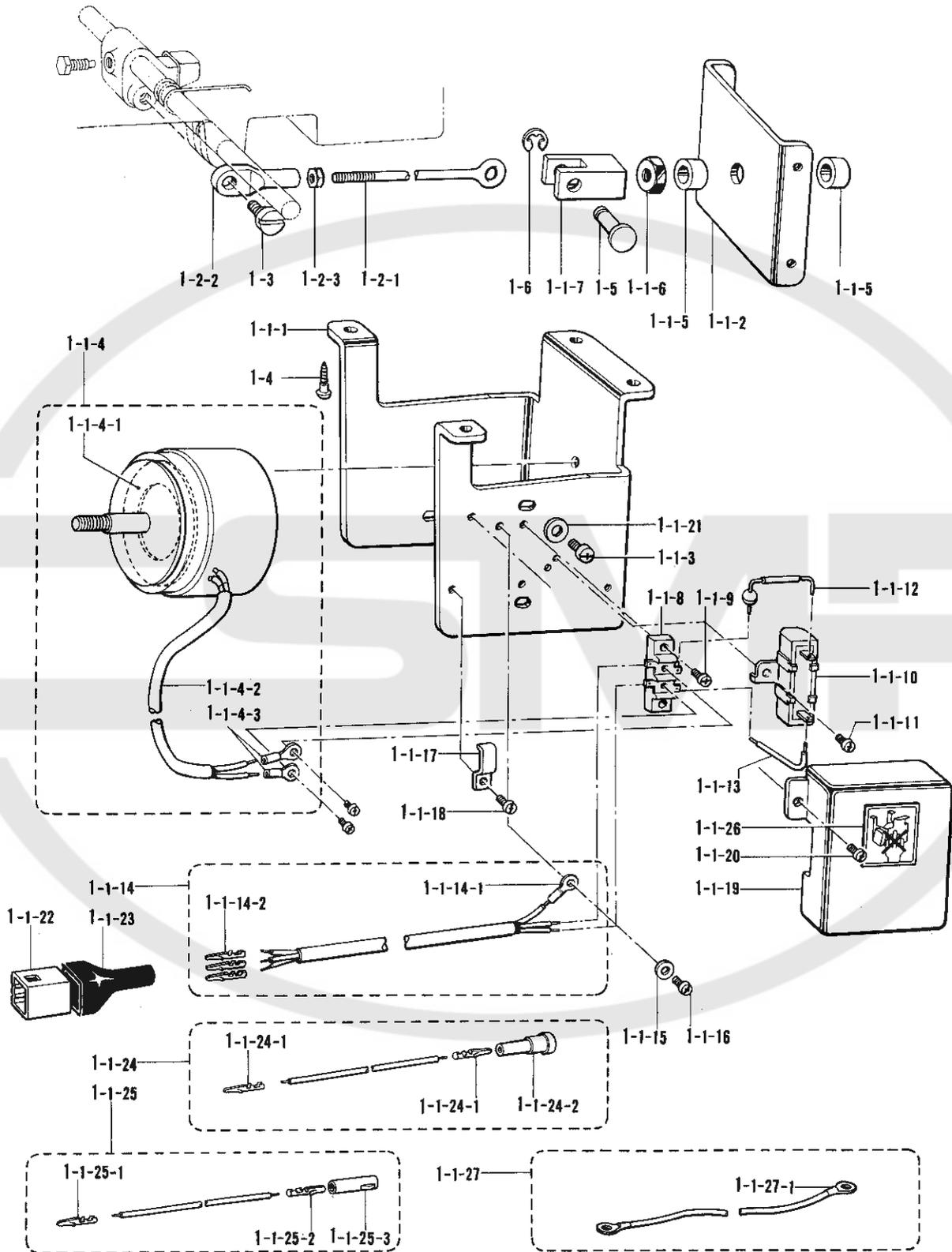
X1. 電磁押工上げ関係 / Presser foot lifting solenoid set/Solenoidsatz für die Anhebung de Stoffdrückerfußes/
