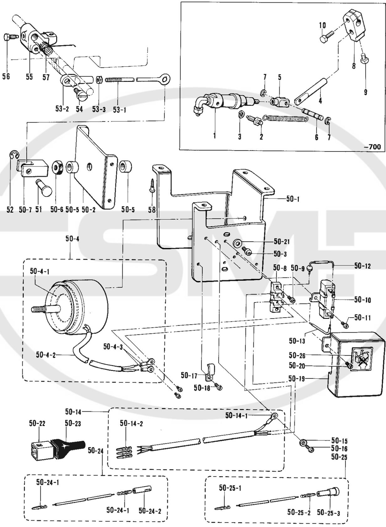
G. 押工上ゲ関係/Presser foot lifter mechanism/Stoffhalterhebevorrichtung/
