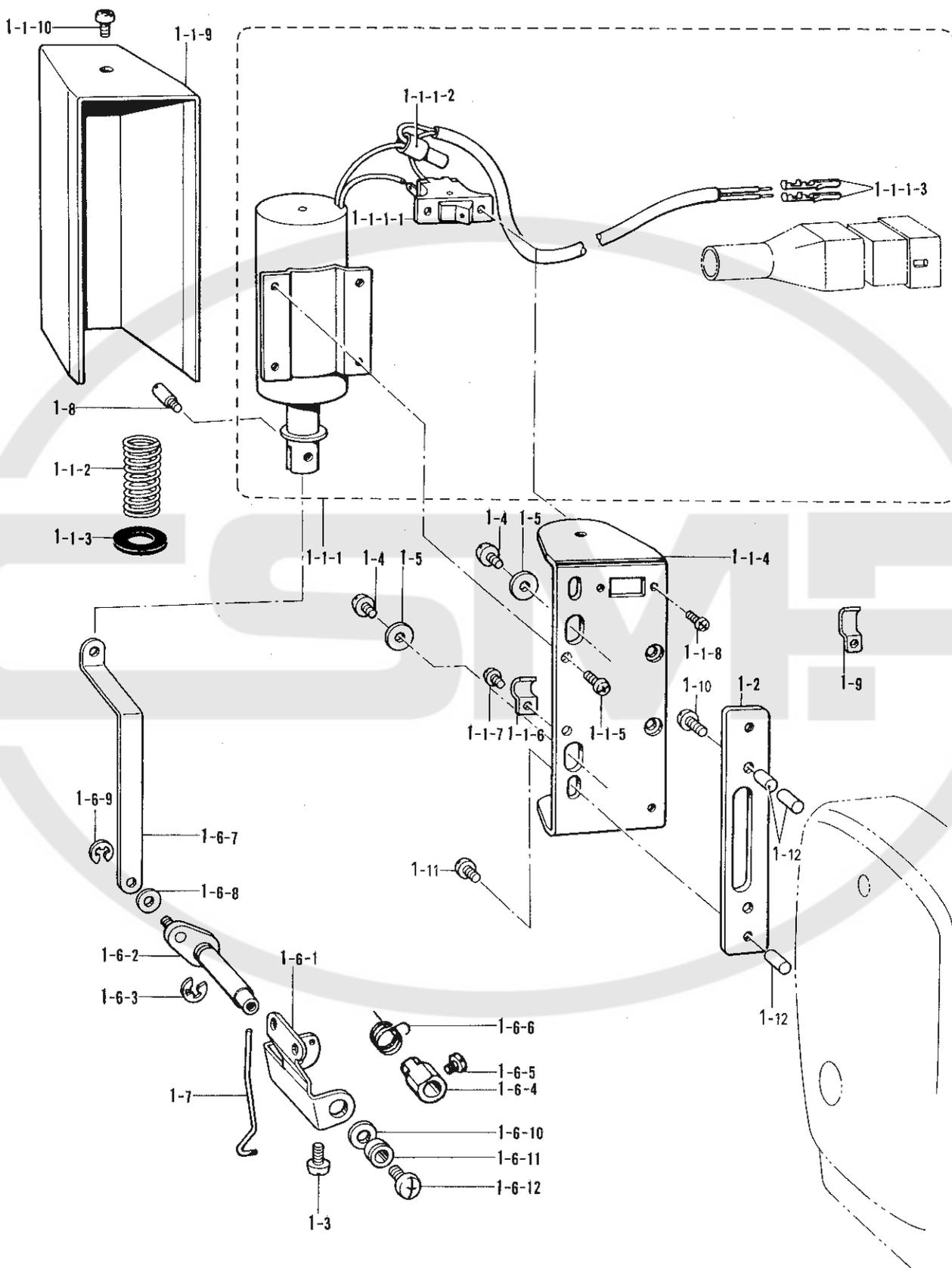
Z. 糸払イセット / Thread wiper set / Fedenspannvorrichtung /
