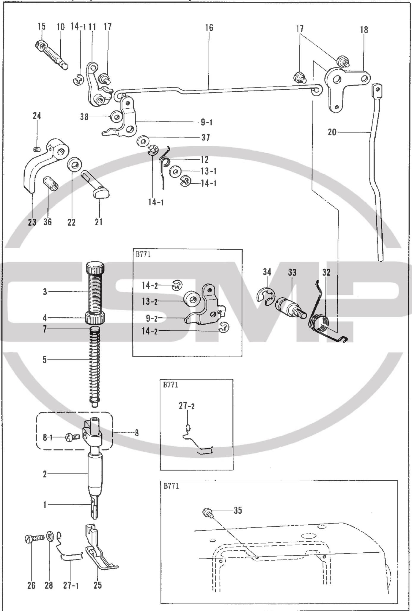
E. 押工関係 / Presser foot mechanism / Stoffdrückerfuß /
