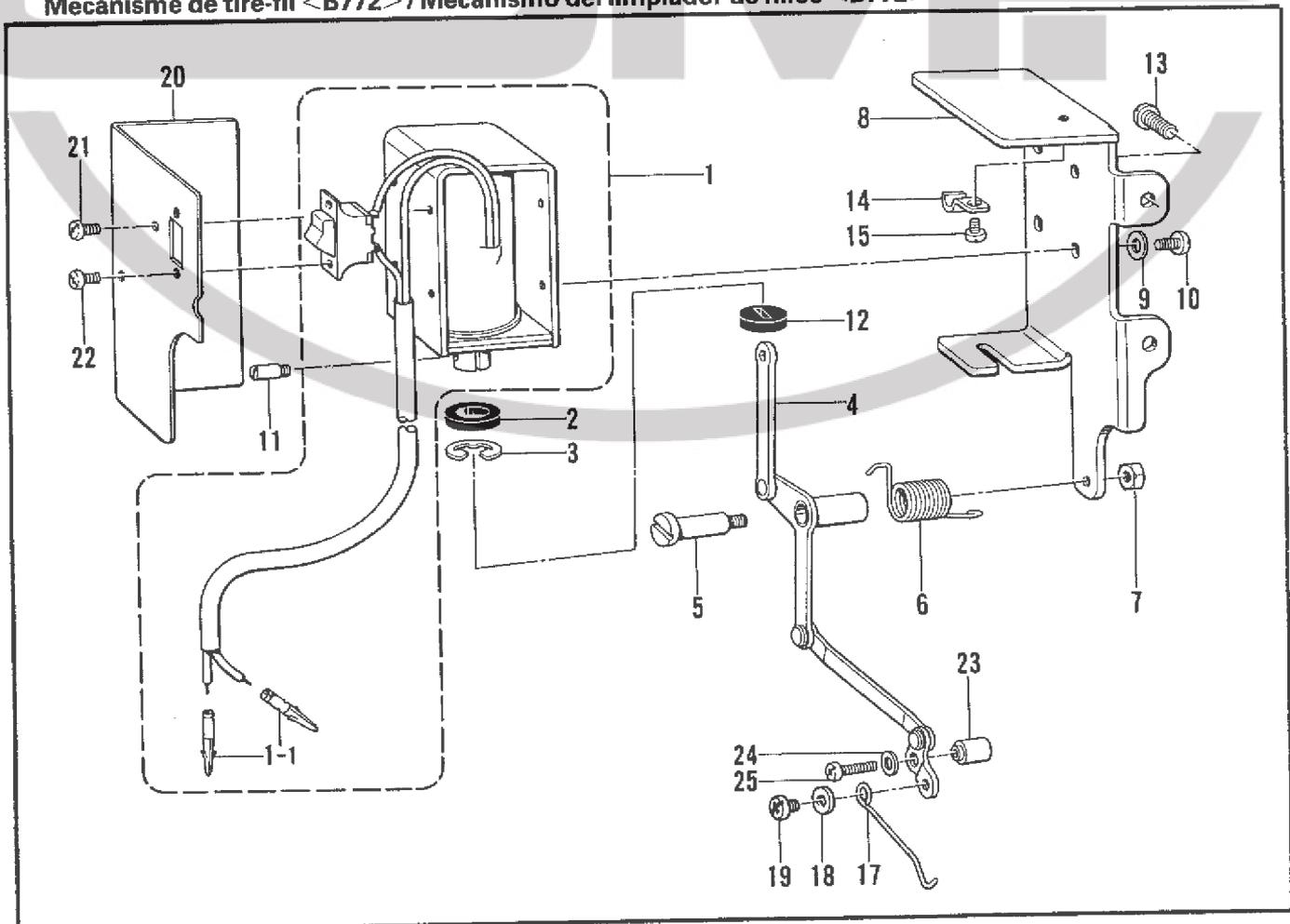
P. 糸ユルメ関係 <B772> / Tension release mechanism <B772> / Spannungsverminderungsvoorrichtung <B772> /
