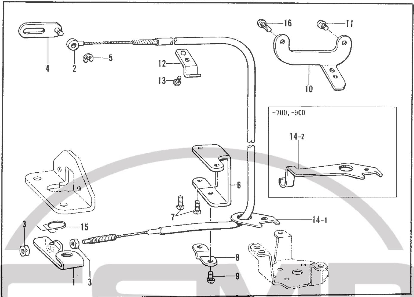
Q. 糸払い関係 <B772> / Thread wiper mechanism <B772> / Fadenwischvorrichtung <B772> / Mécanisme de tire-fil <B772> / Mecanismo del limpiador de hilos <B772>
