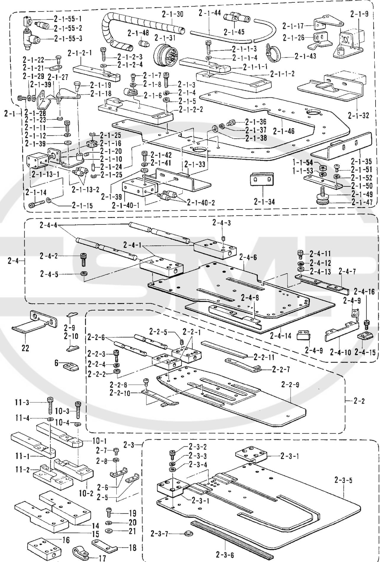
K. 折り曲げ関係/Folding margin mechanism/Faltungsvorrichtung/
