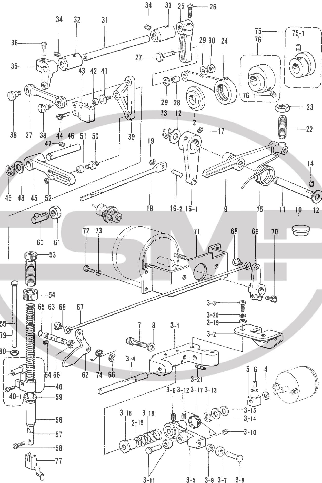
E. 押工上げ関係/Work clamp lifter mechanism/Stoffhalterhebevorrichtung/
