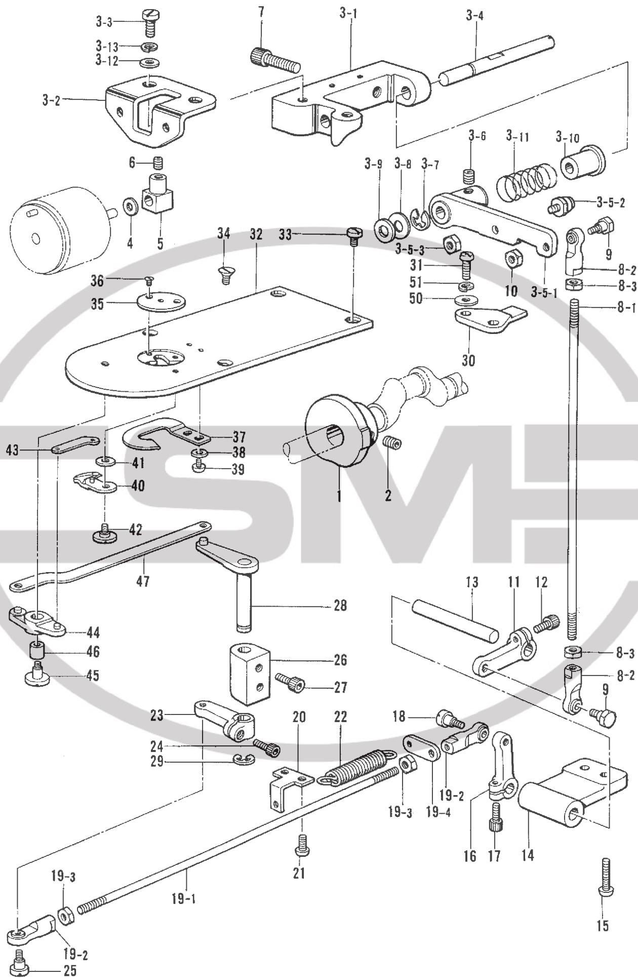
L. 糸切り関係/Thread trimmer mechanism/Fadenabschneidevorrichtung/
