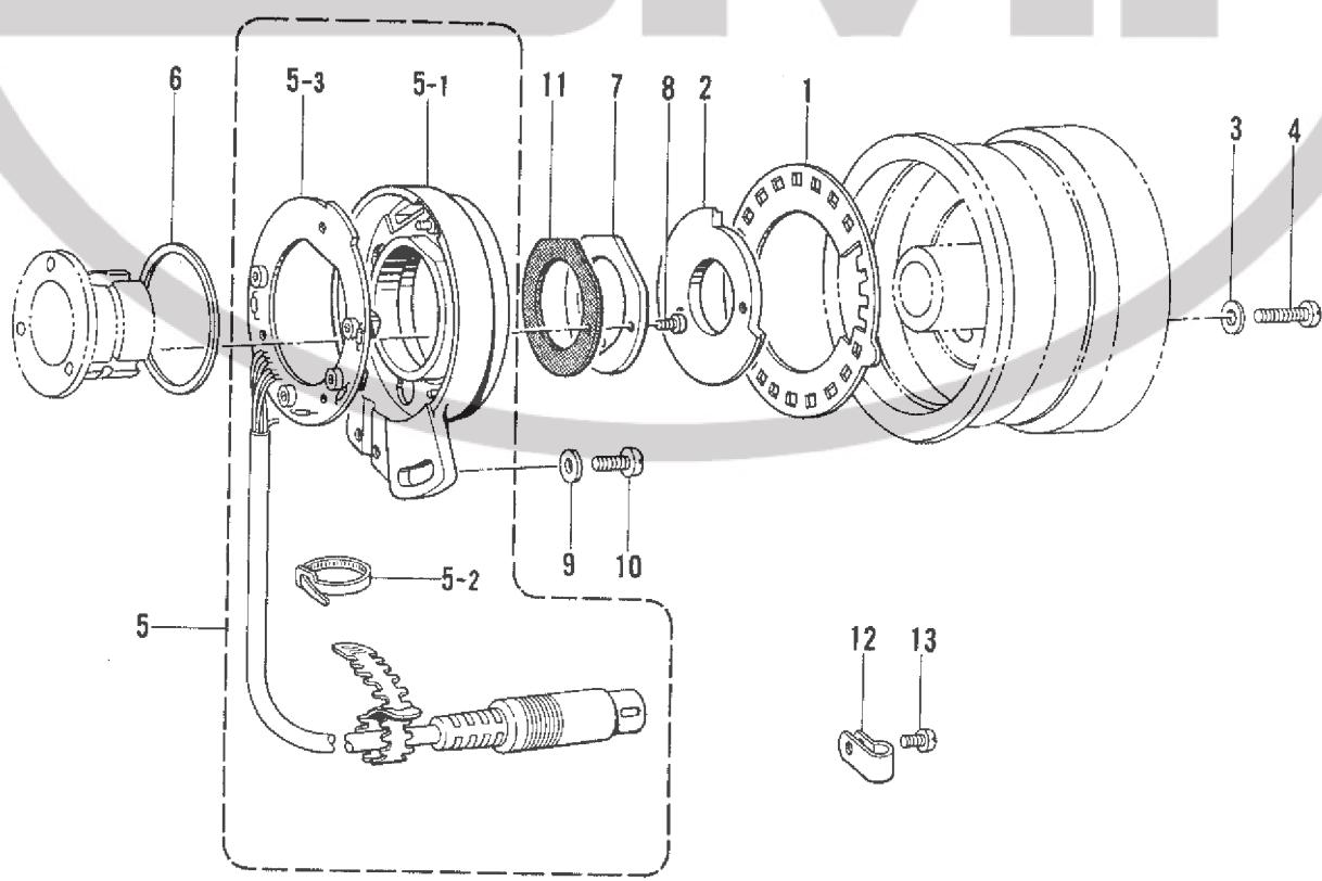
M. ワイパー関係 / Thread wiper mechanism / Fadenwischvorrichtung /
