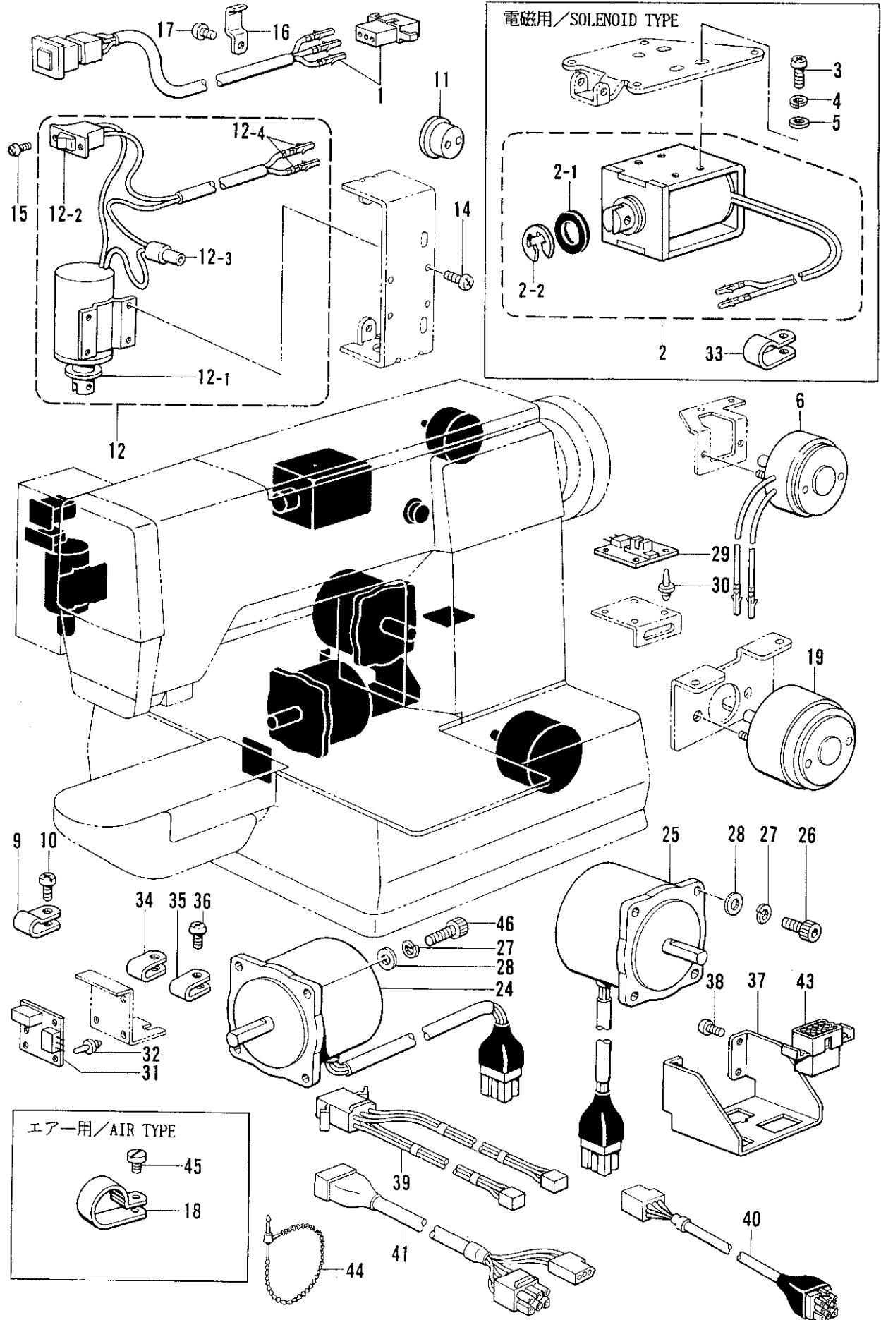
Q. 電源機関部 / Power supply equipment mechanism / Schaltkasten / Mécanisme de l'équipement en alimentation électrique / Mecanismo de la equipo de alimentación de corriente
