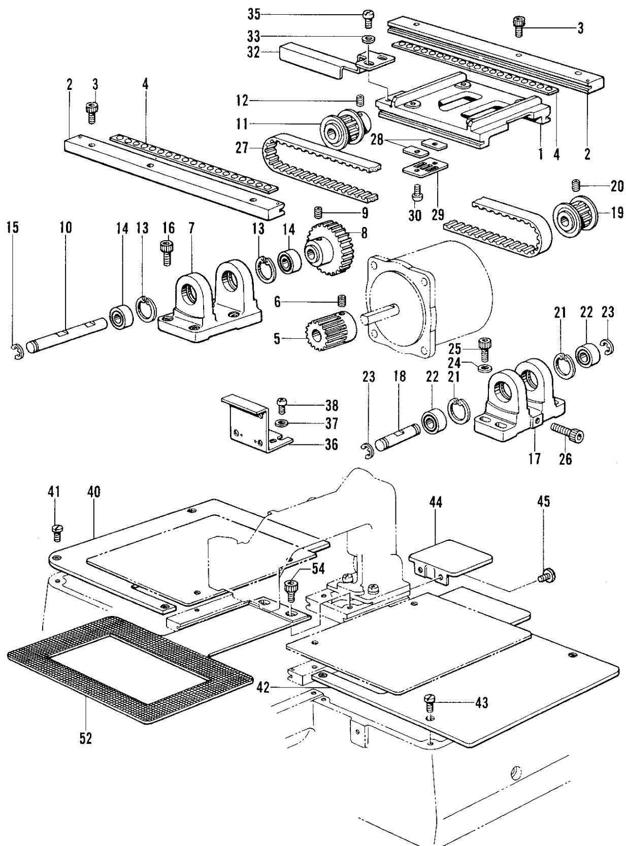
1. 駆動関連機体 / Feed guide mechanism / Transportführung /
