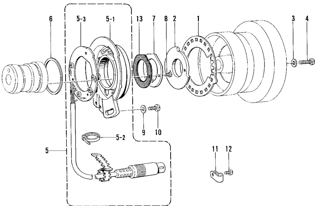
VI. ナット / Thread wiper mechanism/Fadenwischvorrichtung/
